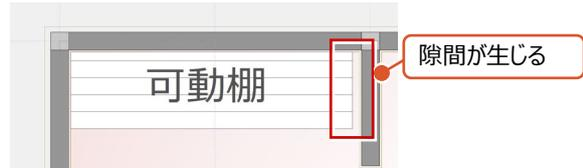
その場合は Modelio の壁厚を ZERO で作成される壁厚（仕上げ厚含む）に合わせておくと隙間なく連携されます。
