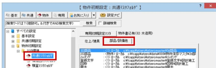
3 「2D 部品」をクリックして、マスタパスが「<物件> ローカル ○:¥FCAPP¥ATZERO¥ (物件フォルダ) ¥物件保存マスタ¥2d 部品」になっていることを確認します。
