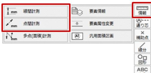
2 寸法がわかっているところの距離の始点と終点をクリックします。計測した数値より実際の縮尺を算出します。
