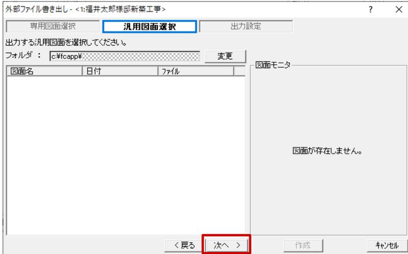
5 「出力設定」でファイルの書き込み先を設定します。今回は「任意フォルダに出力」を選択し、「変更」から出力先をデスクトップに設定します。
