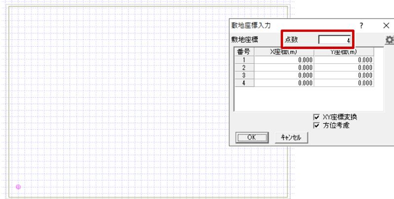
**5** 「X座標」の番号1のセルをクリックして、CtrlキーとVキーでコピーしたExcelの座標を貼り付けて、「OK」をクリックします。
