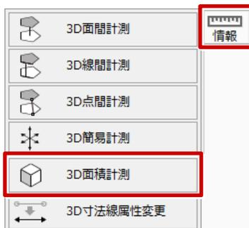
2 計測する屋根を選択すると、「面積計測」ダイアログが表示され、面積が確認できます。
