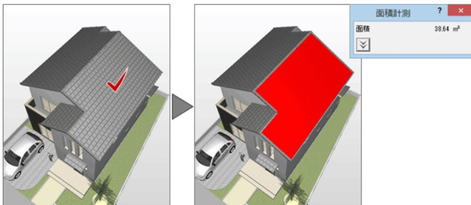
3 計測する外壁を選択して、表示された「面積計測」ダイアログの拡張ボタンをクリックすると開口面積も確認できます。
